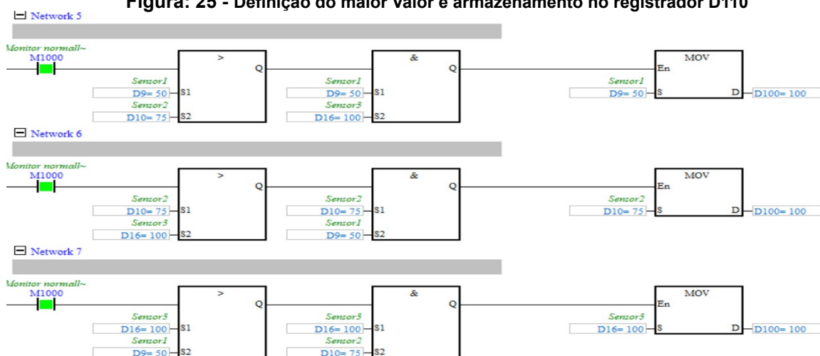
Figura: 25 - Definição do maior Valor e armazenamento no registrador D110
