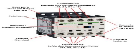
Figura : 15 – Contactor de Auxiliar
